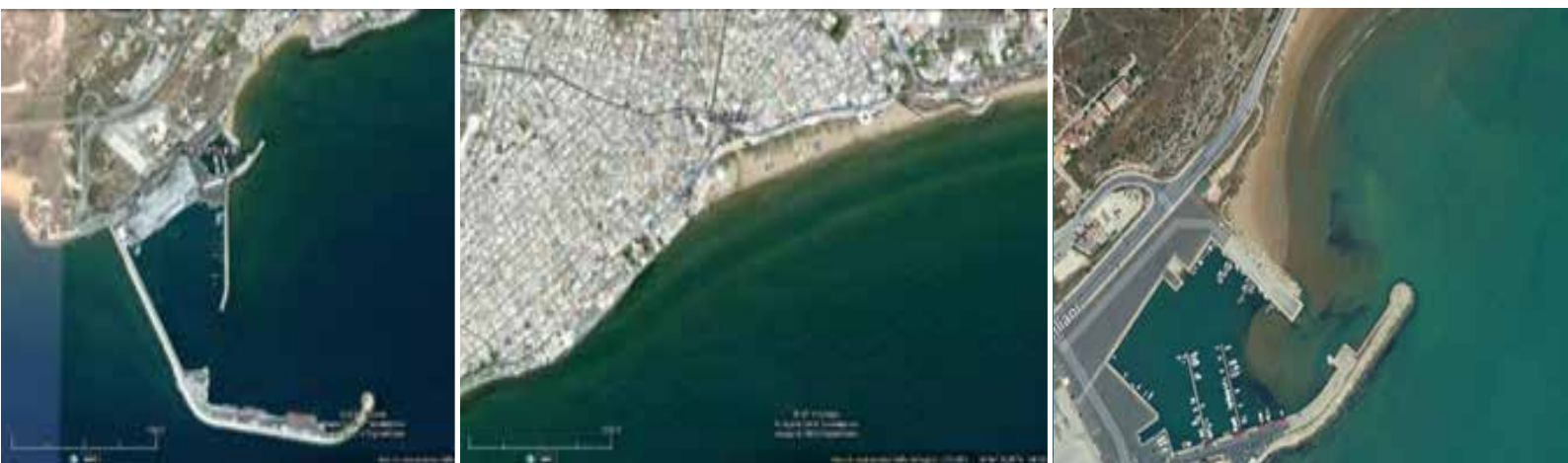
Da sinistra: il Porto di Pozzallo; la Spiaggia di Pietre Nere Pozzallo RG Fenomeno di insabbiamento dopo la realizzazione del Porto di Pozzallo; il Porto Piccolo Pozzallo: evidente fenomeno di insabbiamento. Sotto: Costa dal porto di Pozzallo fino a Punta Castellazzo a S. Maria del Focallo (Ispica).
